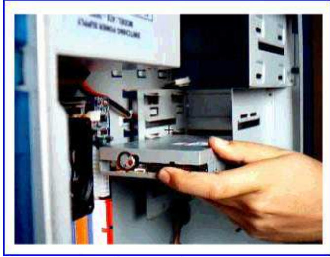
(شكل : يوضح تركيب محرك الأقراص المرنة داخل ال Case)
