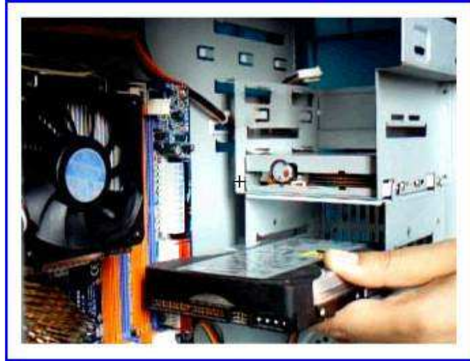
(شكل : يوضح تركيب القرص الصلب داخل ال Case)
