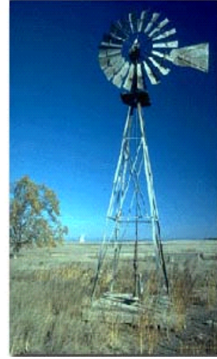
شكل (31): توربينة رياح تستخدم في ضخ المياه
