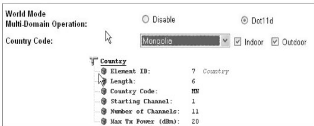
التعديل 802.11d عرف أيضاً معلومات مخصصة ل FHSS AP مثل FHSS parameters هذه المعلومات يجب أن ترسل داخل beacon or probe response frames هذه المعلومات يمكن أن تكون مفيدة في الأجهزة القديمة التي تستخدم تقنية FHSS
