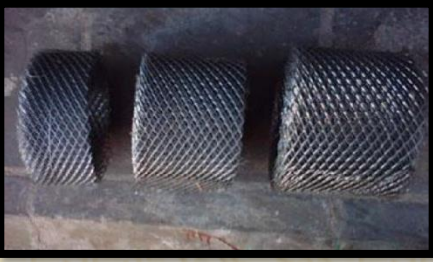
الشّد الممدد المستخدم في تغطية مواسير الكهرباء
