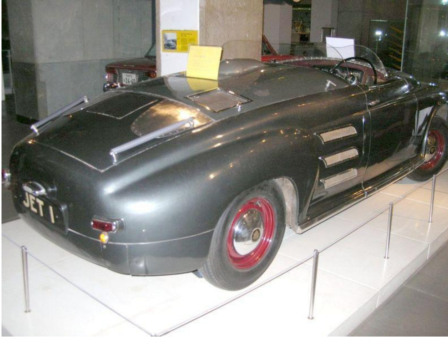
الشكل ( ٢٠٠ ) مركبة بتوربين غازي نفاث ( مركبة للقيادة فوق الأراضي الوعرة ) نوع Rover - Jet1
