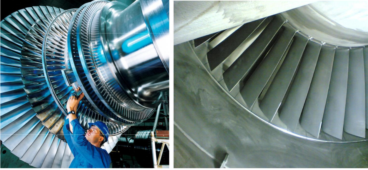
الشكل ( ١٣٦ ) المرحلة الأخيرة لتوربين غازي نوع سيمنز SIEMENS ( الجانب الأيسر توربين بخاري والجانب الأيمن توربين غازي )
