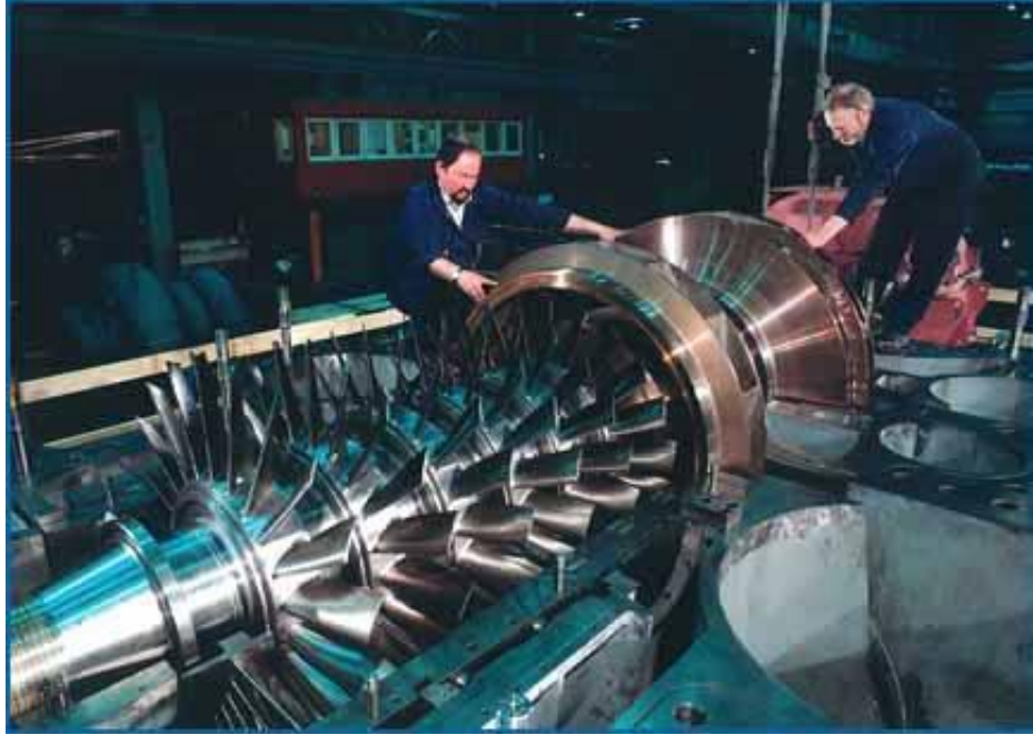
الشكل ( ١٩٩ ) ضاغط مركب ( محوري - طرد مركزي ) Combined Axial & Centrifugal Compressor
