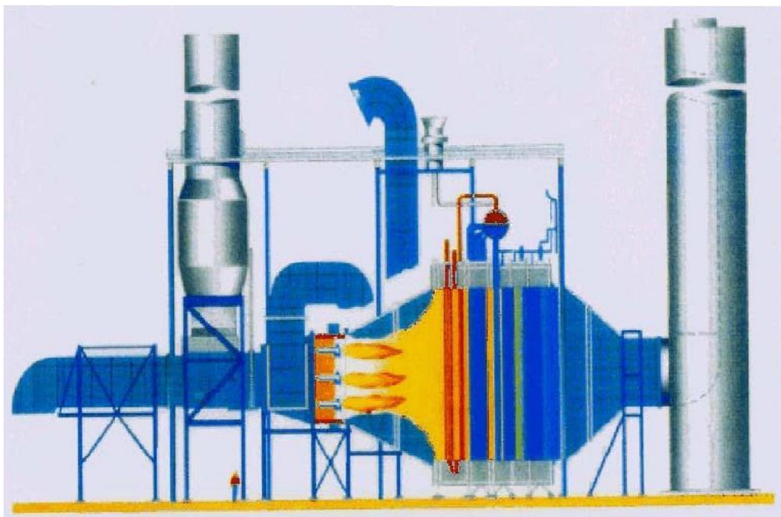
الشكل ( ١٧٨ ) HRSG مع الأشعال التكميلي supplementary firing
