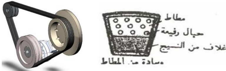
شكل (4) يبين سير اسفيني عل شكل حرف V
