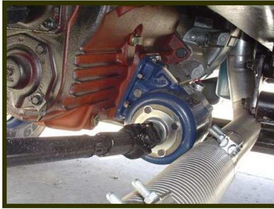
الشكل رقم (11) يبين شكل وطريقة التثبيت على عمود نقل القدرة P. T. O الخلفي في الساحبة
