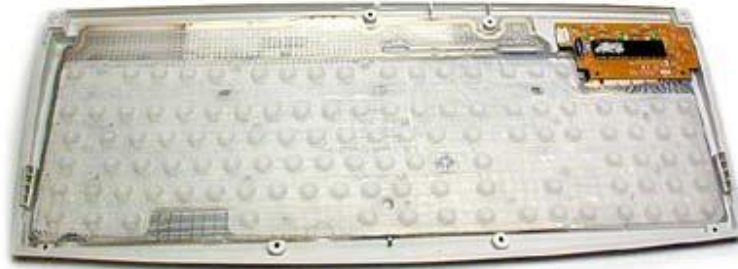
تستخدم لوحة المفاتيح هذه القبة المطاطية
