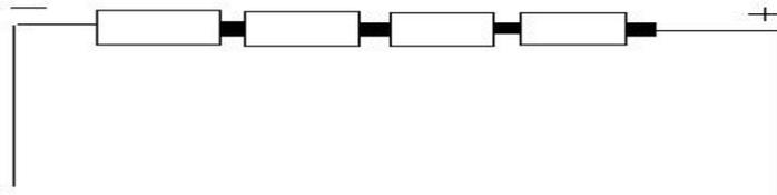
وتصبح المقاومة الكلية  $R_1+R_2+R_3=R_T$
