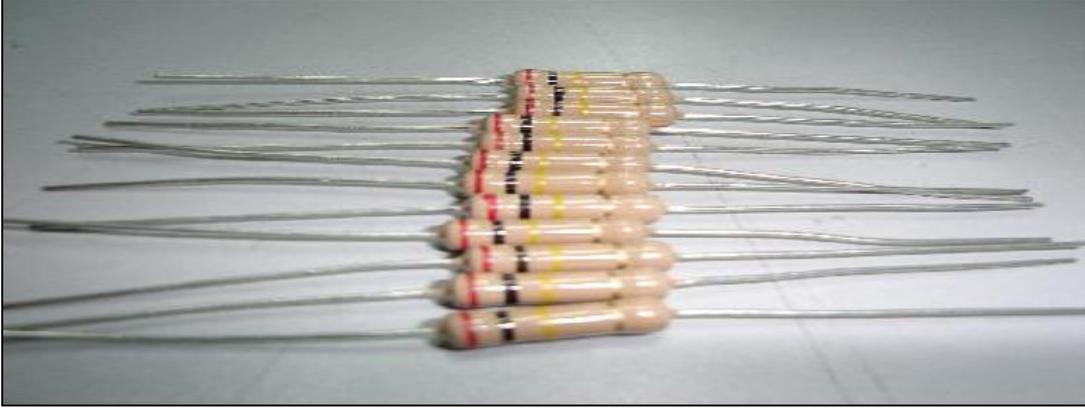
هي مقاومة المادة لحور التيار الكهربائي ويرمز لها بالرمز
