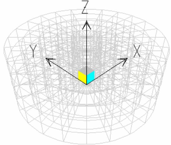
\* لتعديل خطوط الشبكة ننقرها بالماوس نقر مزدوج فيظهر مربع حوار ( شكل 4- 2 ) ولإضافة خطوط الشبكة في إتجاه محور Z ندخل 13, 14, 15 مع Z Direction = 13, 14, 15 مع النقر على زر Add Grid Line لكل إضافة .
