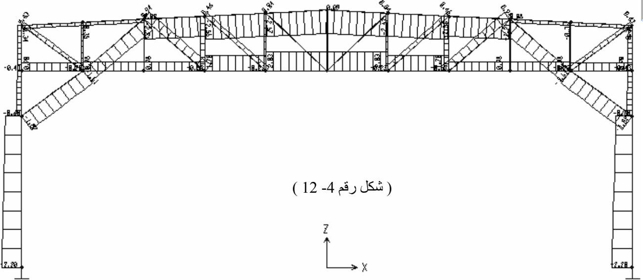
\* للتأكد من تحمل مقاطع المنشأ للإجهادات من القائمة Design نختار أمر Start Design/Check of Structure فيظهر المنشأ (شكل 4-13) وعلية نسبة الإجهاد الفعلي للإجهاد التصميمي  $1 >$  ليتحملها قطاع العنصر لأقصى حالة تحميل افتراضية للأحمال  $DL + LL + WL$ .
