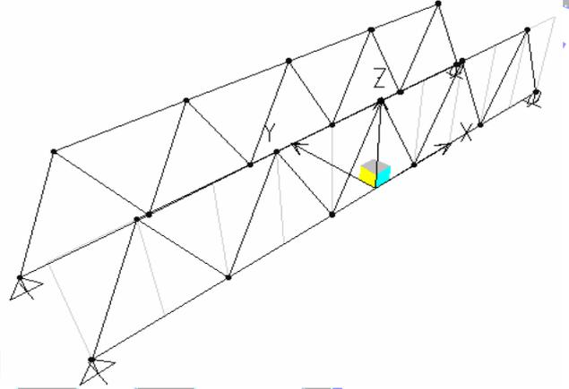
\* من نافذة الرؤية XZ Plan ننقر أي خط شبكة بالماوس نقر مزدوج فيظهر مربع حوار Edit Grid حيث نحدد مربع اختيار Y-Direction ونضيف به خط شبكة Add Grid Line عند Y=144.
