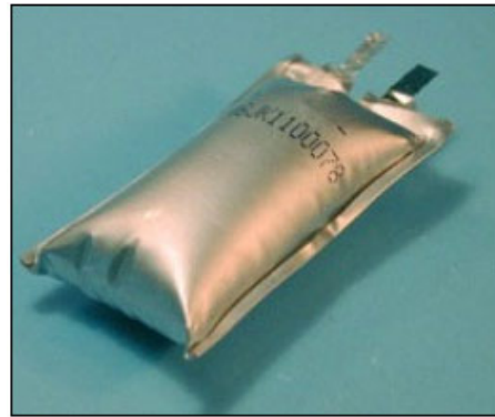
الشكل ٢٢,٢ يبين خلية كيسية منتفخة. الانتفاخ يمكن أن يحدث كجزء من توليد الغاز ومصنعو البطارية مجهلون سبب حدوث ذلك.
